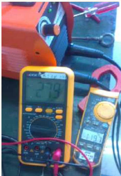
Работа на повышенном напряжении
