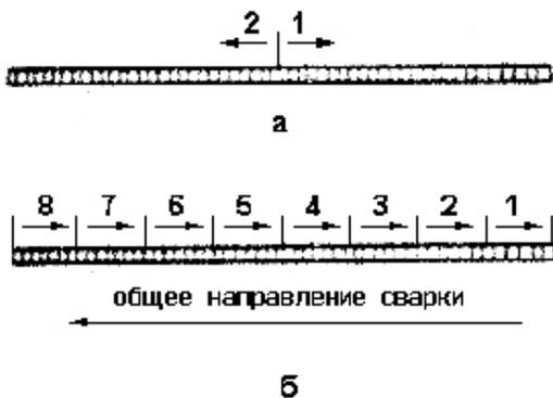
**Рис. 4 Порядок наложения длинных швов**
