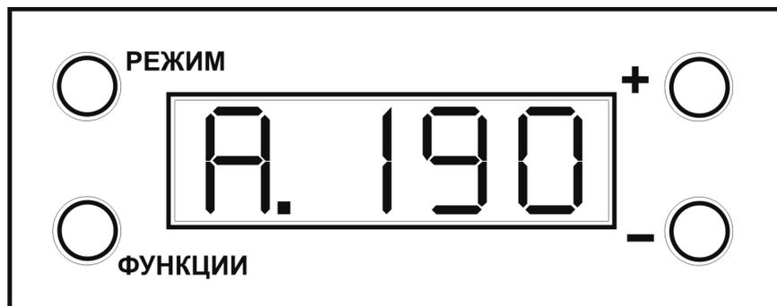
Кнопка **«РЕЖИМ»** - Выбор режима работы. При запуске всегда включается режим работы, установленный перед выключением аппарата. Режимы работы отображаются символами «А.», «А», «U», «b», «t» в первом разряде индикатора.
